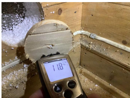
Hulltaking, og baksiden av panel måles tørr.
