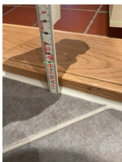
Vanntest: Vann renner mot terskel før vannet renner til sluk.
