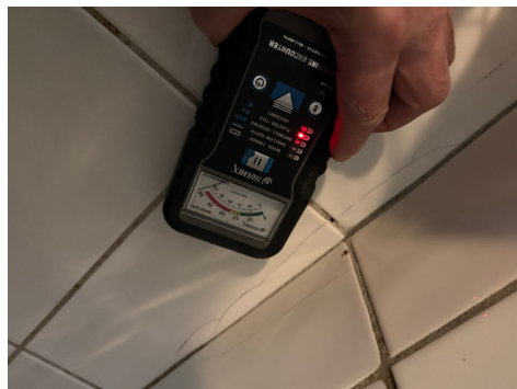
Fuktmåling med (Tramex) fukt indikator i våtsone vegg overflater dusj.
