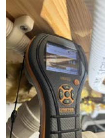
Målt i himling under sluk i vaskerom.
