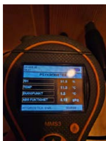
Måling av relativ luftfuktighet i lukket veggkonstruksjon mellom bod og bad. Måling av trefukt i lukket veggkonstruksjon mellom bod og bad.
