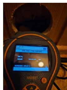
Måling av relativ luftfuktighet i lukket veggkonstruksjon mellom bod og bad. Måling av trefukt i lukket veggkonstruksjon mellom bod og bad.
