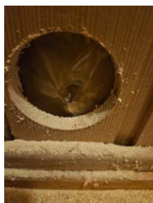
Måling av relativ luftfuktighet i lukket veggkonstruksjon mellom bod og bad. Måling av trefukt i lukket veggkonstruksjon mellom bod og bad.
