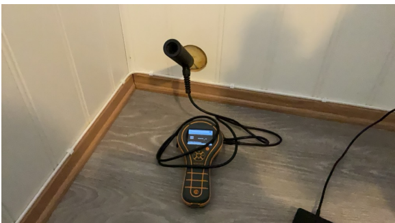
Hulltaking ble foretatt, ved fuktmåling registrerte jeg tørre verdier.
