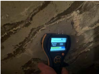
Lokale forhøyede fuktverdier registrert på vegg i matbod.
