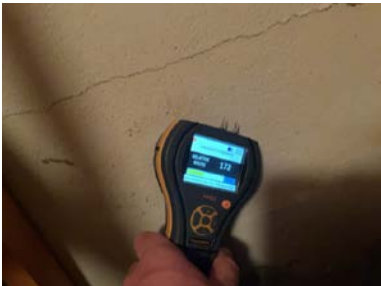
Lokale forhøyede fuktverdier registrert på vegg i matbod.
