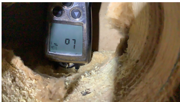
Hulltaking, og det måles tørt.
