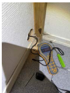
Bildet viser utført måling i vegg i bod som ligger innenfor soverommet.
