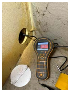
Bildet viser utført måling i vegg under trappen.
