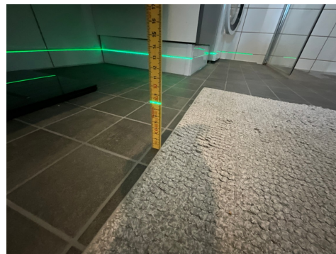
Måling av fallforhold på gulv. Topp laserstrek viser 81mm. Målt fallforhold på 0,8:100.
