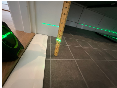
Måling av fallforhold på gulv. Topp laserstrek viser 73mm.
