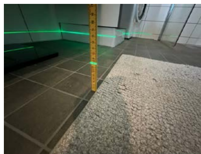
Måling av fallforhold på gulv. Topp laserstrek viser 81mm. Målt fallforhold på 0,8:100.
