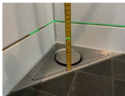
Måling av fallforhold på gulv. Topp laserstrek viser 103mm ved sluk.
