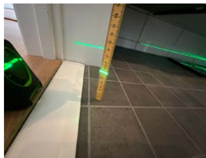
Måling av fallforhold på gulv. Topp laserstrek viser 73mm.
