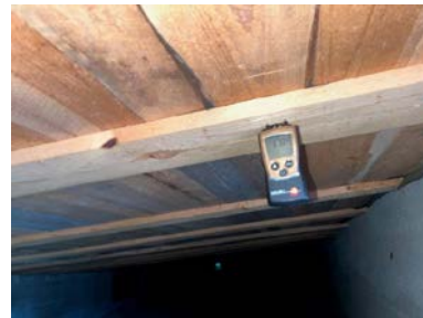
Fukttinnhold på oppunder 20 vektprosent.
