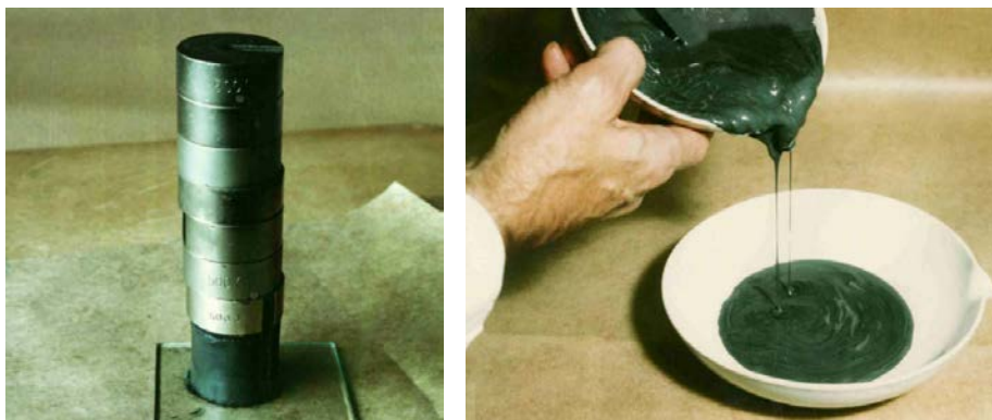
Figur 2.3 Illustrasjon av forskjellen i kvikkleiras egenskaper før og etter en overbelastning. Før brudd kan kvikkleira bære relativt stor last og etter brudd blir leira flytende (Foto: NGI).
