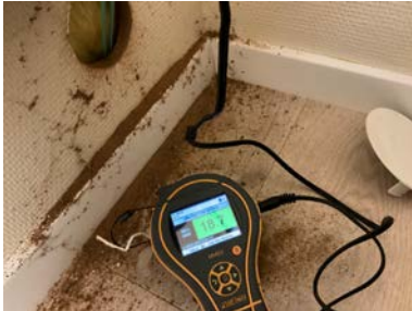
18,7 vektprosent, med dampsperre.
