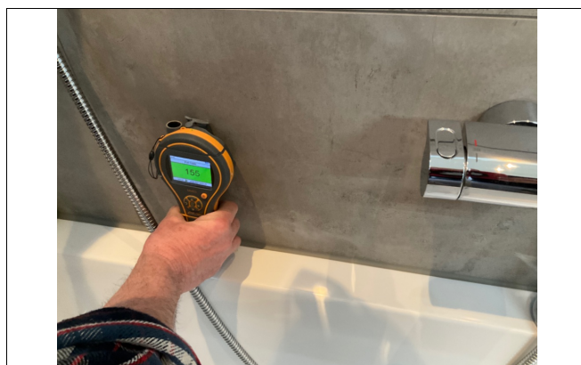
Kontrolløk med fuktmåler på alle våtrom.
