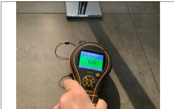
Kontroll med fuktmåler på alle våtrom.
