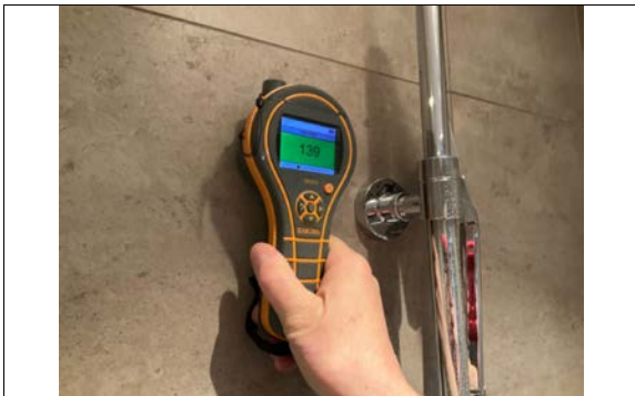
Kontrolløk med fuktmåler på alle våtrom.
