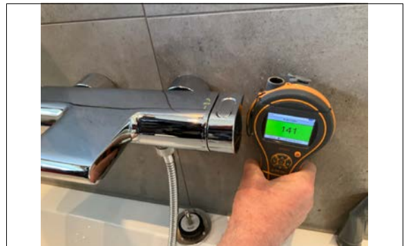
Kontrolløk med fuktmåler på alle våtrom.
