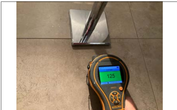
Kontrolløk med fuktmåler på alle våtrom.
