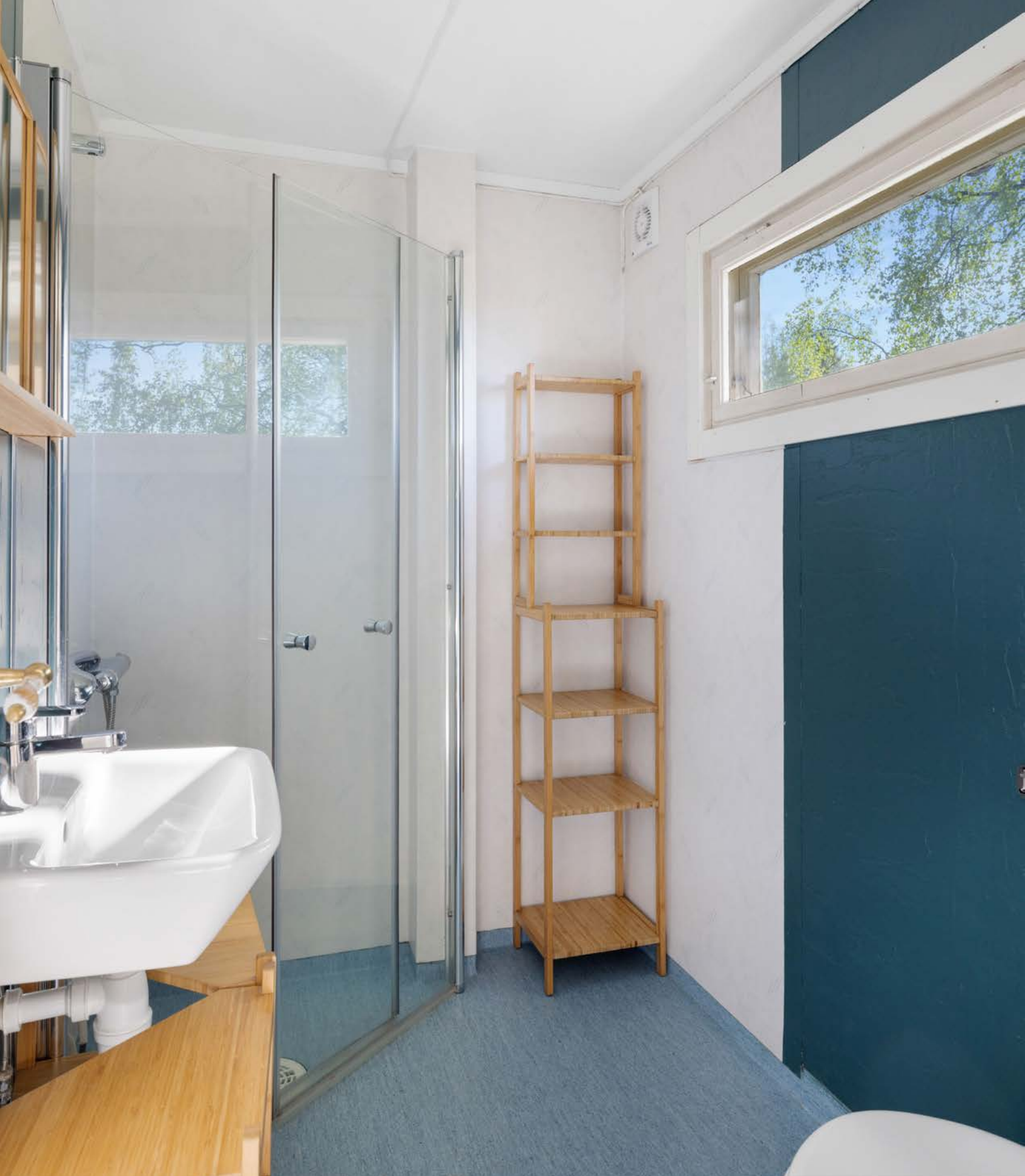
Badet liggeri 1. etasje og har belegg på gulvet. Rommet er utstyrt med gulvmontert toalett, dusjhjørne med innfellbare dører og vegghengt dusjbatteri, samt håndvask.
