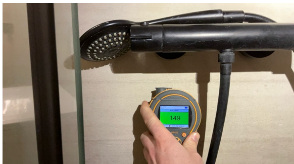
Enkle fuktsøk viste normale verdier.
