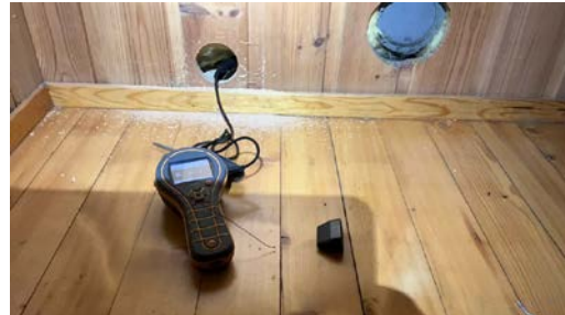
Hulltaking er utført i tilstøtende vegg mot dusj. Fuktmåling viste tørre verdier.
