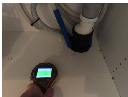
Fuktsøk i benkeskap - ingen påviste forhøyede fuktverdier.
