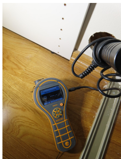
Fuktsøk mot våtrom - Naturlige utslag - ingen forhøyede fuktverdier.
