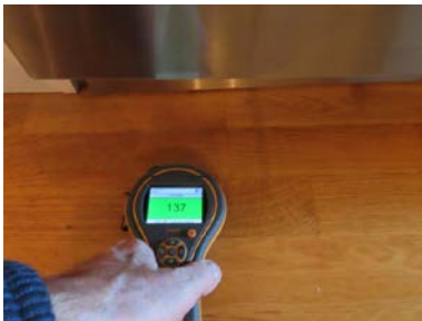
Fuktsøk på gulv foran benkeskap og oppvaskmaskin - ingen påviste forhøyede fuktverdier.
