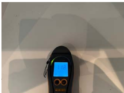
Ingen forhøyede fuktverdier ble registrert i kjøkkenbenken.
