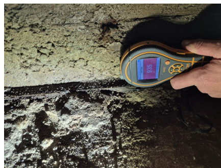
Råte i treverk i bunn og indikert fukt i mur.
