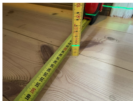
Måling ca to meter fra ytterveggen.
