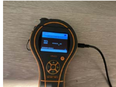
Måling i treverk. Målinger er foretatt uten å påvise unormale forhold. Målingene gir kun et øyeblikksbilde av forholdene og kan endre seg med årstider, fukt- og temperaturforhold.
