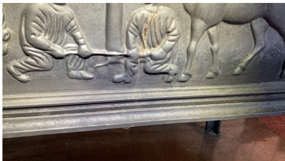
Sprekk/riss i ovn.
