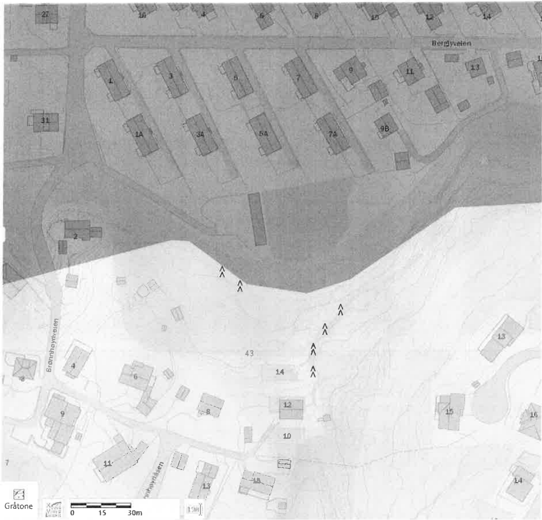
Figur 2-2. Løsmassekart og berg i dagen kartlagt på befaringen ( ). Lys- og mørkeblå områder indikerer tynne og tykke marine avsetninger henholdsvis. Rosa områder er berg. Ekvidistansen er 1 m. Kilde av løsmassekart: atlas.nve.no .
