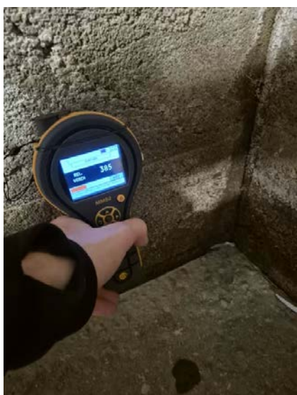
Viser fuktmåling, måling viser indikasjoner på fukt i nedre del av grunnmur.
