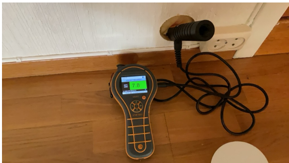
Hulltaking utført fra tilstøtende rom.
