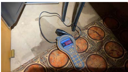
Det ble registrert forhøyet verdi på gulv ved stoppekran.
