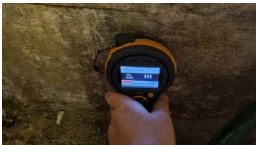
Det ble registrert forhøyde fuktverdier i rom under terreng.
