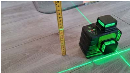
Kontroll av planavvik.
