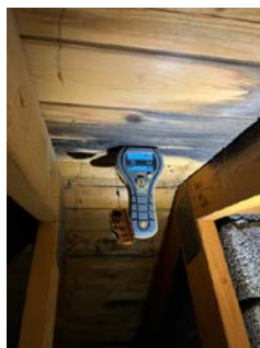
Fuktmåling ved gjennomføring av pipe viste normale verdier.
