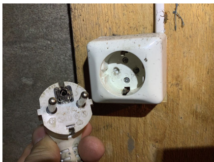
Bildet viser utilfredsstillende el-tilkobling iht. gjeldende forskrift.
