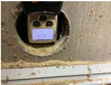
Bildet viser hulltaking og at det måles tørt.
