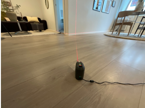
Nivellering stue + soverom, ingen avvik registrert
