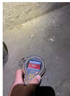
Ved fuktmåletaking av teknisk rom i kryprom var det fuktutslag
