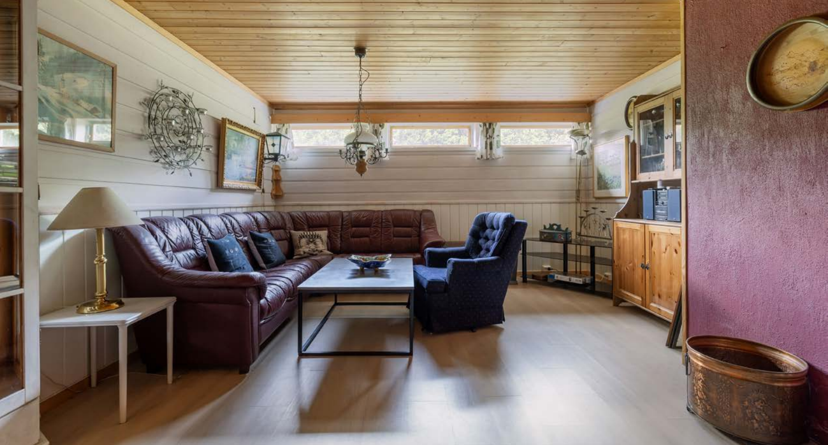
Rom i kjeller er innredet som kjellerstue. Rommet er ikke søkt bruksendret og har for små vinduer til at disse er godkjent som rømningsvei. Rommet er derfor ikke godkjent til varig opphold.
