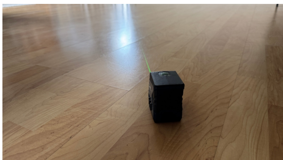
Kontroll av planavvik.
