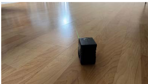
Kontroll av planavvik.
