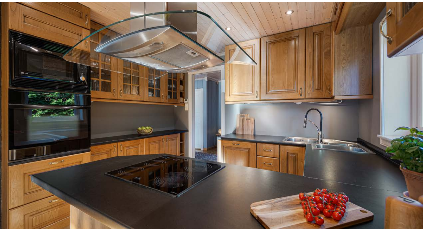
Den takhøye innredningen er av eik og har profilerte fronter, vitrineskap og laminatbenkeplate med trippel oppvaskkum i stål.
