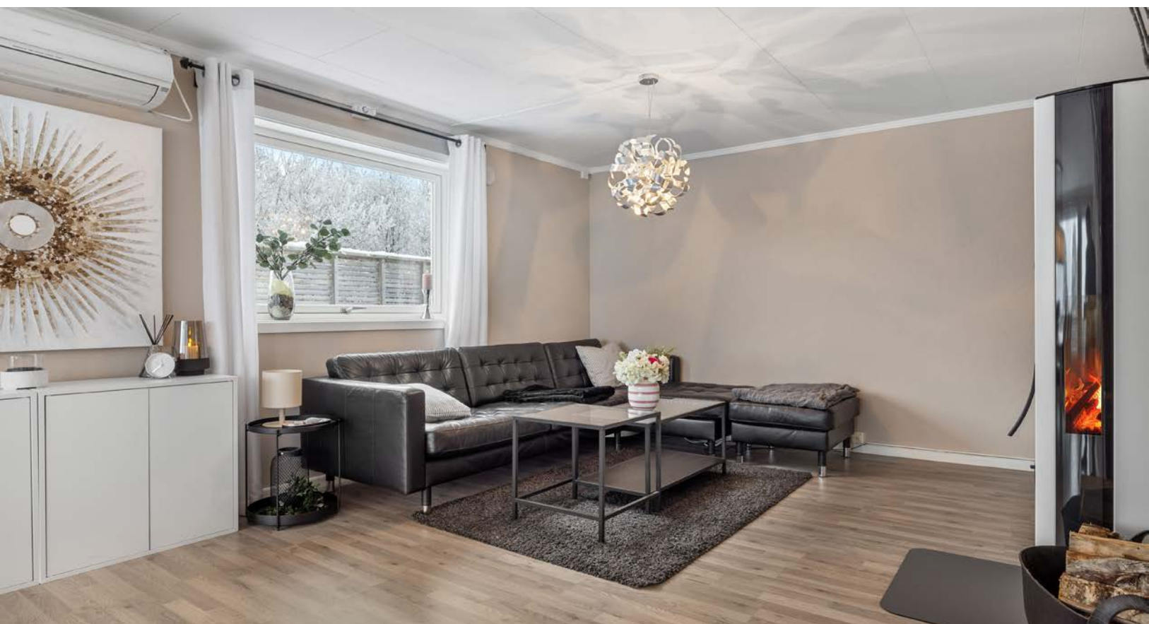
Stuen har både peis og luft-til-luft varmepumpe som sørger for god varme på kaldere høst- og vinterdager. Ytterveggene ble også tilleggsisolert med 10 cm mineralull i 2017.
