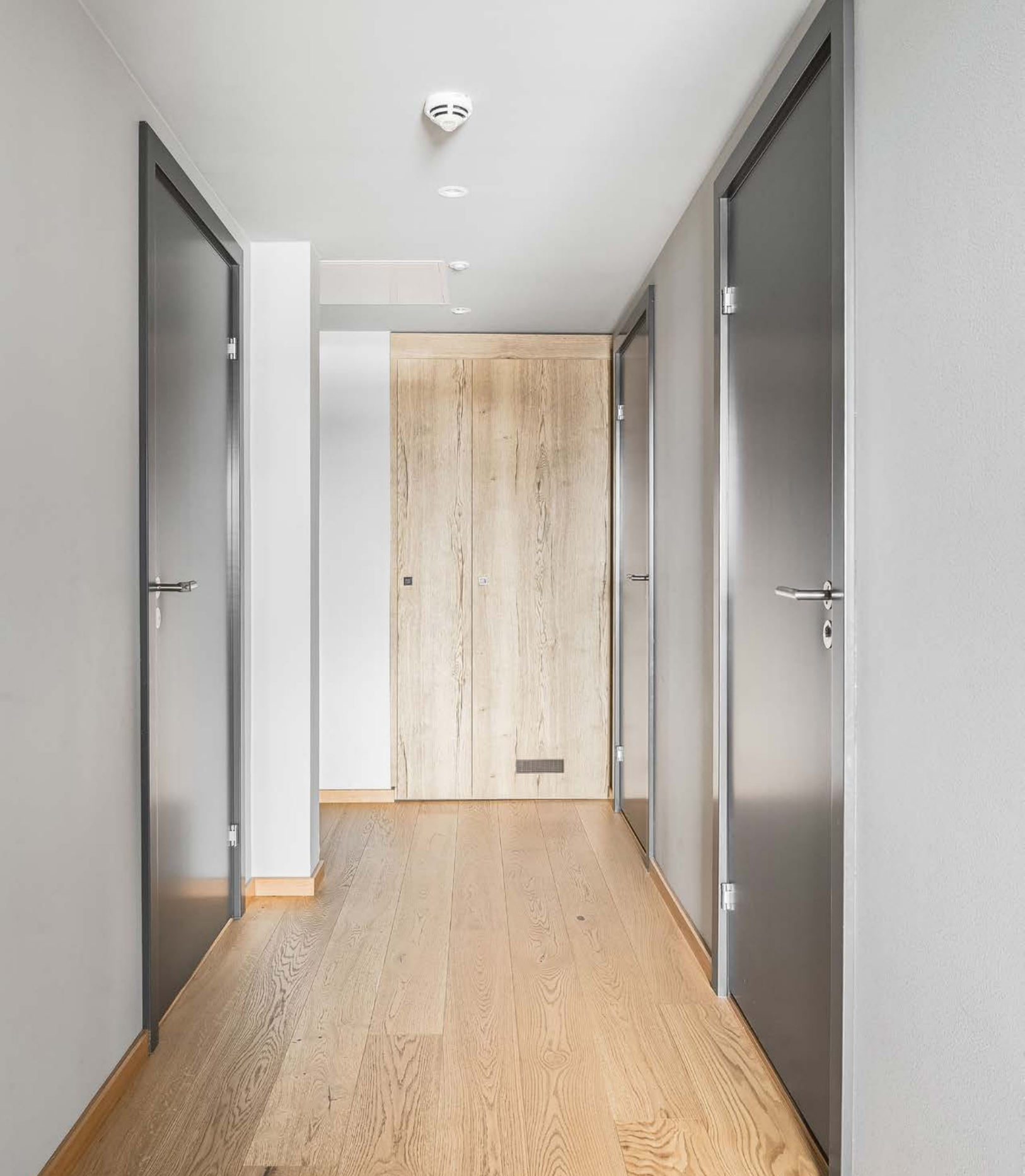
Gang med adkomst til 3 soverom og 2 bad. God standard med enstavs eikeparkett på gulv, glatte lysmalte overflater, skjult elektrisk anlegg og downlights i himlingen.
