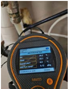
Måling av relativ luftfuktighet i lukket veggkonstruksjon mellom kjøkken og dusjsone.
