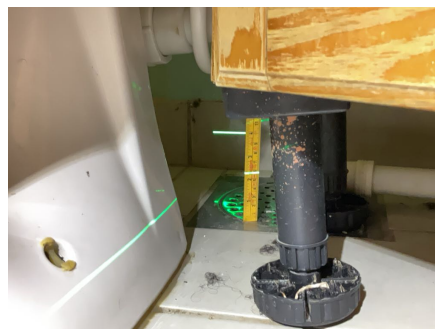
Målt fall til sluk: 9mm.
