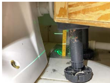
Målt fall til sluk: 9mm.
