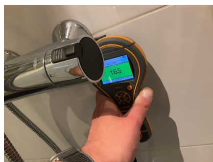
Enkelt fuktsøk med indikator på erfaringsmessig utsatte steder viste ingen unormale verdier.
