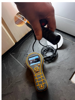
Ingen utslag ved fuktmåling i hulltaking i vegg mot dusjsone. Målingene som er gjort er å betrakte som stikkprøver og sier bare noe om tilstanden i nærheten til området der målingen er utført.
