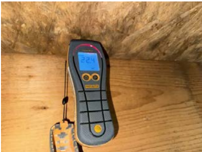
Misfarging tegn etter fukt/kondens i OSB i taket.
