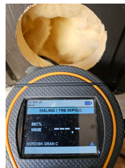
Måling av trefukt i lukket veggkonstruksjon mellom entré og vaskerom.
