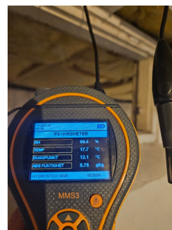
Måling av relativ luftfuktighet i kjeller.
