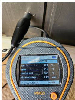
Måling av relativ luftfuktighet i lukket veggkonstruksjon mellom entré og vaskerom.
