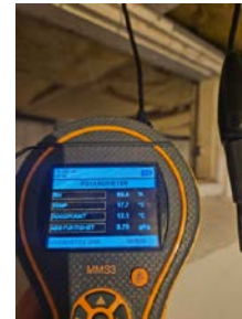
Måling av relativ luftfuktighet i kjeller.
