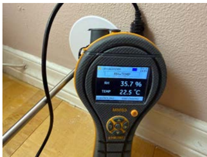
Måling av relativ luftfuktighet.
